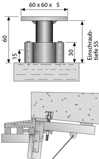
Befestigungsteil mit metrischem Gewinde, Verschluss mit Stopf 20.
