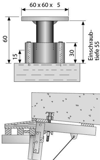
Befestigungsteil mit metrischem Gewinde, Verschluss mit Stopf 20.
