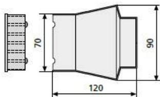
Hinterlässt ein konisches Loch im Beton zum Einsetzen von Fassadenplatten-Ankern, Steinschrauben etc. Die dünnwandige Dübelbox wird nach dem Ausschalen mit einer Zange leicht aus dem Beton herausgezogen. Der Halteflansch ist wiederverwendbar.
