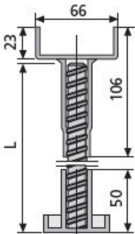
Höhenverstellbarer Rüttelbohlenhalter, wird in die Bewehrung eingebunden. Der RÜBO®-Kunststoff-Fuß mit Nagellaschen verhindert Korrosion. Der RÜBO®- Kopf ist wiederverwendbar. Vor dem Abbinden des Betons entfernen!
