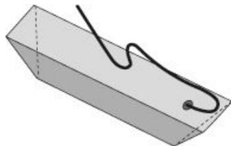
Linien-Abstandhalter für senkrechte Bewehrung zur Betonrohrfertigung u. a.
