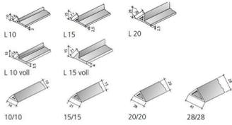
Dreikantleisten aus schlagfestem Hart-PVC, Nagelfahnen gelocht zum Brechen von Ecken.
