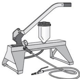
Verpressgerät zum Injizieren von Zement
