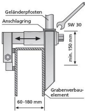
Klemmbare Geländerpfostenhalterung zum Einsatz an Grabenverbau-Elementen. Geeignet für Element- bzw. Wandstärken zwischen 60 und 180 mm.
