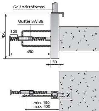
Geländerpfostenhalter zur Aufnahme von BETOMAX®-Geländerpfosten an Überbaurändern von Brücken.
