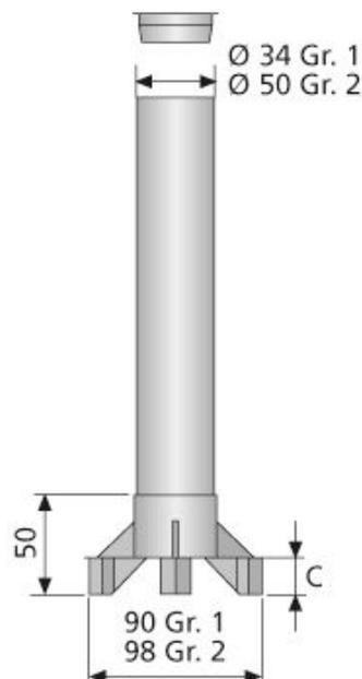
Geländerpfostenhalter zur Aufnahme des BETOMAX®-Geländerpfostens im Bereich von Deckenrändern. Einbau auf der Schalung im Randbereich von Decken (Einbauteil verbleibt im Beton).
