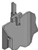
Geländerpfostenhalter zur sicheren Montage von BETOMAX® Geländerpfosten auf Spundwandprofilen und ähnlichen Bauteilen mit einer Materialstärke bis 27 mm.
