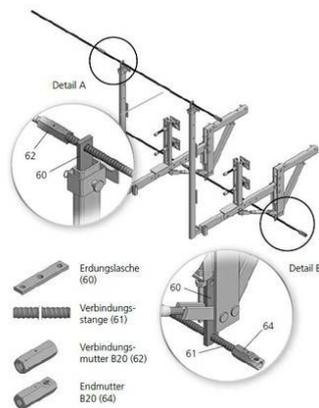
Zur Erdung des Kappengerüsts über elektrifizierten Bahnstrecken.
