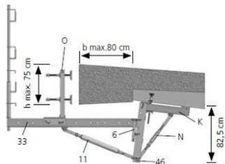
Für weit auskragende Kappengesimse im Brückenbau.
