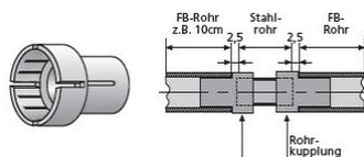
Verbindungsstück aus Kunststoff für Distanzrohr Stahl  $\varnothing$ 22 mit Distanzrohr FB 22.
