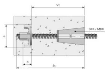
Für einseitige Verankerungen. Die maximale Belastung hängt von der Betongüte und der Verankerungstiefe ( $V_t$ ) ab. Kompatibel mit Uni 15.
