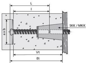
Geeignet für einseitige Verankerungen. Einsatz z.B. für Kletterschalungen, Gerüstkonsolen und Bauwerke mit geringer Wanddicke.
