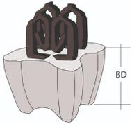
Der Gießbetonabstandhalter hat eine 4 Punkt Aufstandsfläche. Die Doppelklammer verklammert sich gut an den Bewehrungsstahl. Der Abstandhalter kann sowohl an stehender und an liegender Bewehrung montiert werden. Die Montage ist an Bewehrungs- Ø 6-16 mm möglich.
