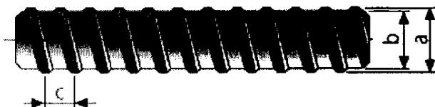
Bild 1: Ankerstab Betomax B20
